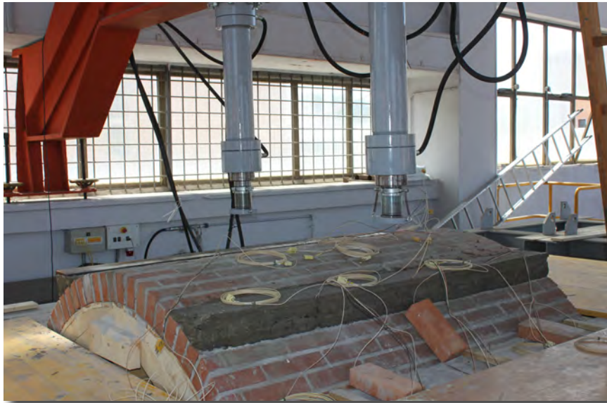
Fig. 74 - Prove di resistenza al fuoco su una volta, all'interno dell'edificio del forno
